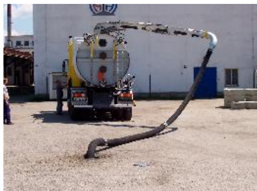
Odstraňovanie tekutých látok z miest ťažko prístupných
